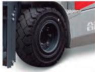
Ruedas superelásticas específicas para carretillas eléctricas de baja resistencia.
