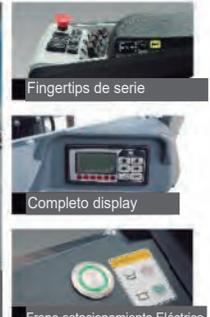
El apoyabrazos multifuncional integra el control hidráulico por fingertyps, el inversor de marcha, el selector de modo de conducción, el claxon, el paro de emergencia, etc., para tener todo bajo control con la máxima precisión.
